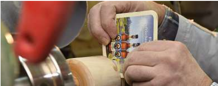
Mit einem Bierdeckel als Schablone wird der Zylinder in Kugelform gebracht.
