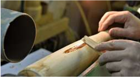
Kleine Stellen, wo zum Beispiel Rinde eingewachsen war, werden mit Sekundenkleber stabilisiert.
