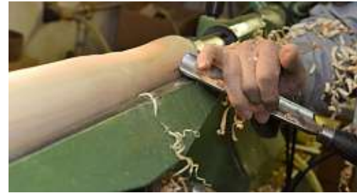
Mit dem Drechseisen wird die Pfeffermühle in Form gebracht.
