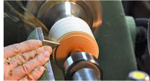
Aus einem Zylinder entsteht anschließend der runde Kopf.
